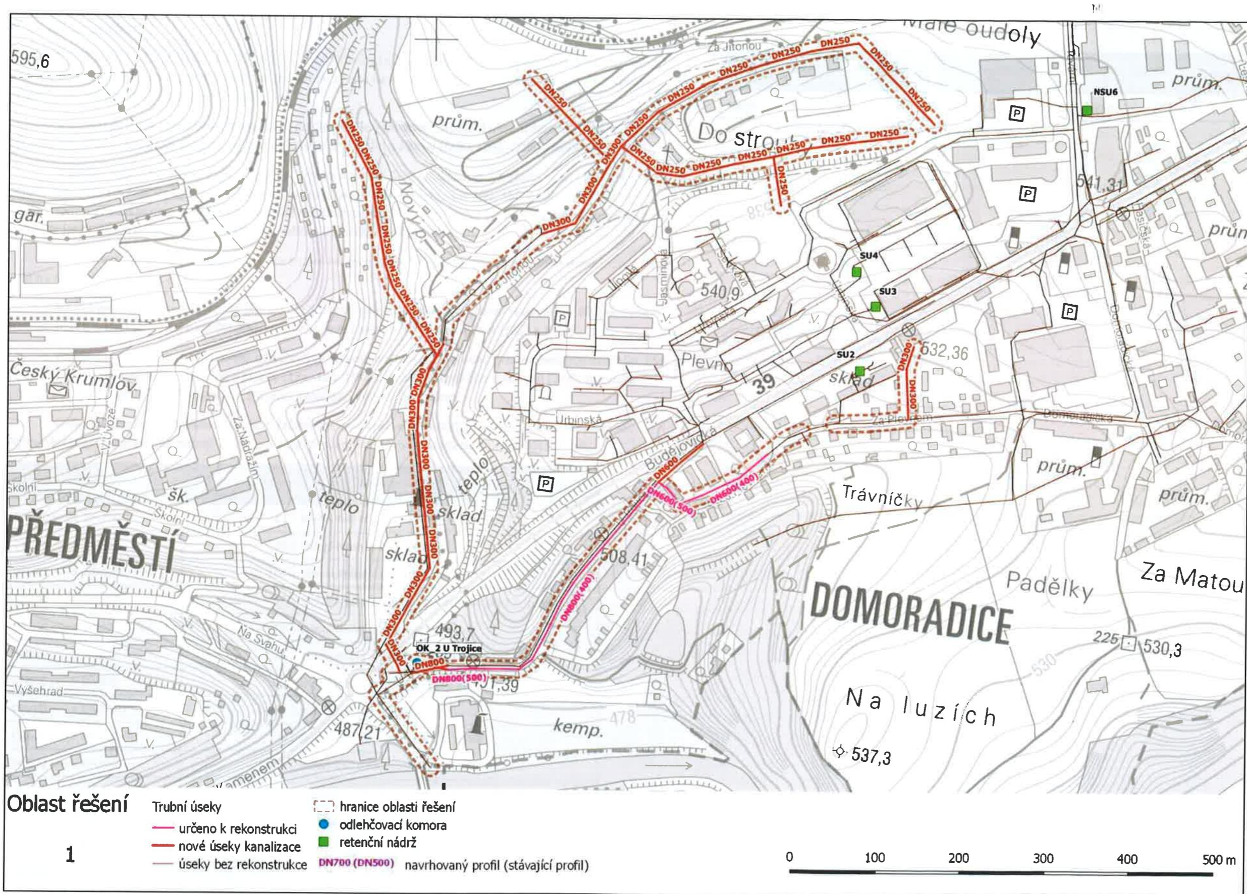
Obrázek 35 - Oblast řešení 1 – Návrh rekonstrukcí U Trojice
